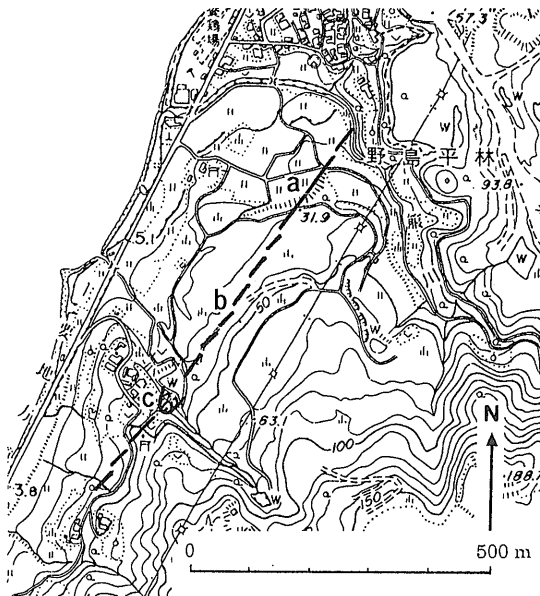
第36図 地変および広義の地震断層を誇張した模式図<1/10,000北淡町図に記入>。 a,bおよびcは第35図に対応。
