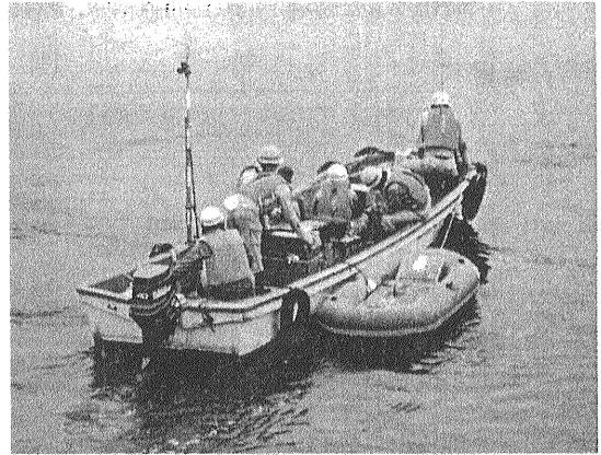
写真1 地中レーダによる水面からの測定状況。
