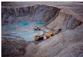
3. ひとすくい30m 3 のパワーシャベルと120t積みのダンプトラックが24時間体勢で採掘している。
