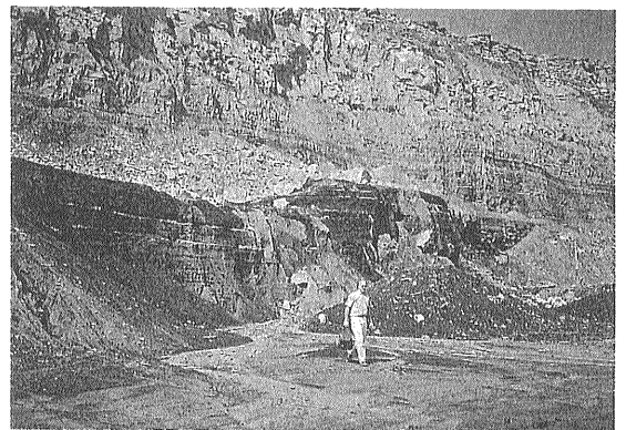
第22図 タイユエン層第二部層上部のNo.6炭層。タイユエン層の主要稼行炭層。ところどころに薄いパーティングがみられる。
