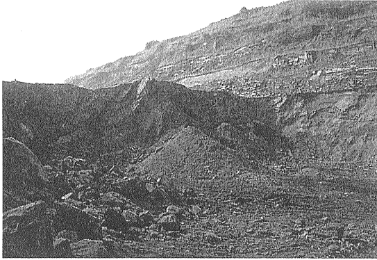
第2図 ラオカイ鉱山の露天採掘場。 高品位の燐灰石を採掘中の露天切羽。高品位 鉱は軟らかく脆いので、粉状になるものも多 い。
