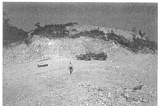
第11図 タンマイ鉱山の露天採掘場. 最良質の鉱石を産出する切り羽. 2台のトラックにこぶし〜人頭大の塊鉱が手積みされる.
