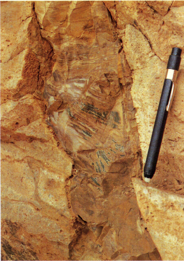
4. Rodalquilar鉱床の含金カルセドニー脈(Au15g/t, 幅15cm). 母岩は珪化変質を受けたデイサイト.
