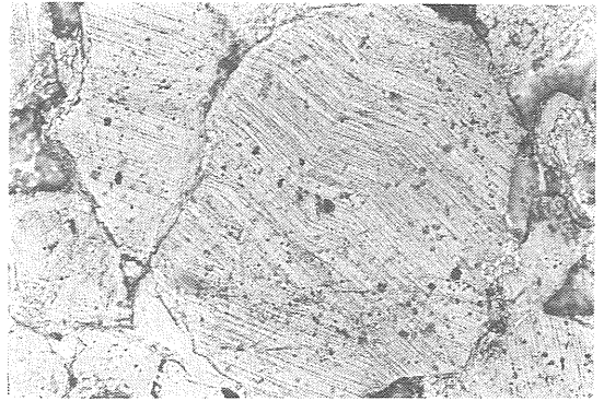
写真14 変形ラメラの発達した石英粒子。写真の横幅が0.44mm。
