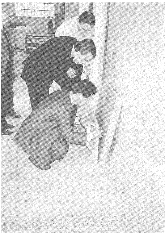
写真6 板材の寸法検査
