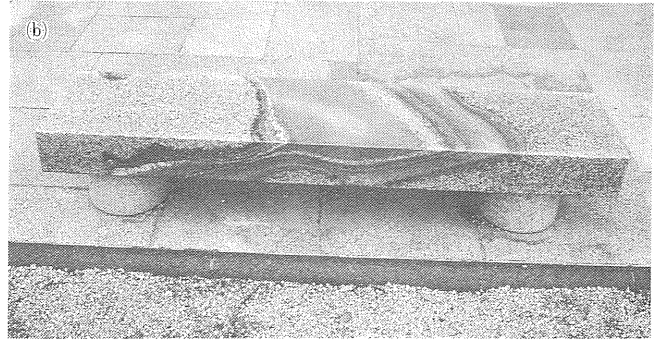
写真15 ベンチに使われた特異な紋様〔博石館の庭※〕—花崗岩のなかの同心円状 (a) および縞状 (b) のジュリーレン
