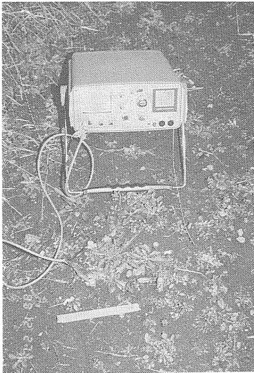
写真5 電磁波式土壌水分計による野外での水分量の測定。ロッドの間隔は10cm。付属品がなくかつ本体も軽いため、中性子法に比べて機動性に富む。
