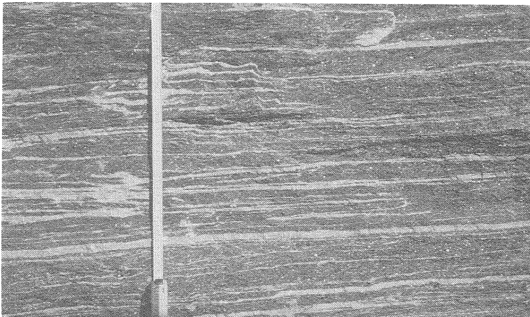
写真4 東鉱体の鉱石=角閃石-黒雲母-石英片岩。細粒の灰重石結晶が, 石英に富む白色部に鉱染している。光って見える小斑点は黒雲母の結晶。口絵4, 6参照。
