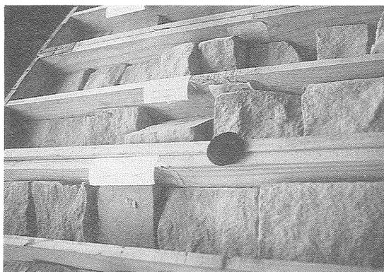
写真20 トラフ型斜交葉理及びリップル葉理をともなった砂岩 (古第三系沙河街層第三段上部)。
