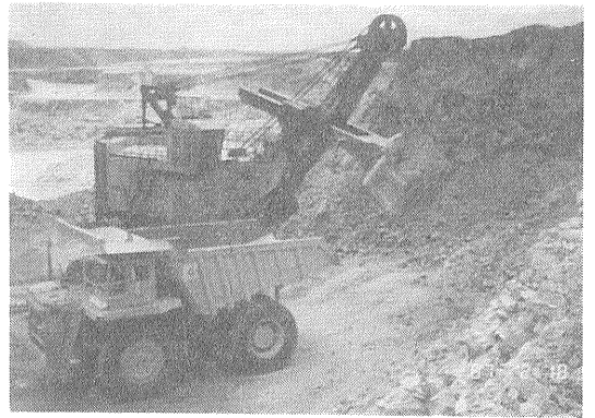
第7図 ダンプトラック(92トン積み)への鉱石積み込み作業。 (ワイズヒル露天採掘場)
