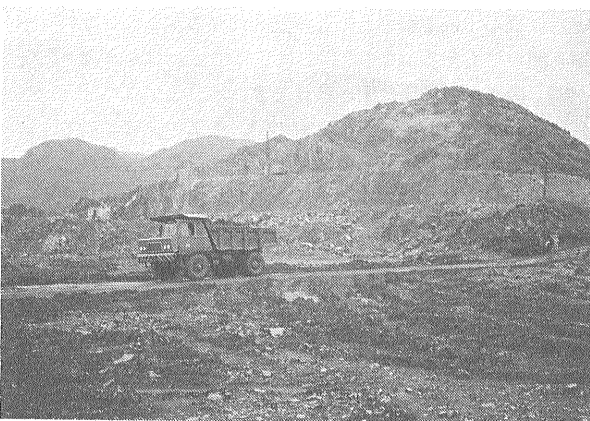
開発準備中の大斗山鉱床。網状に発達した細脈中に、平均0.7%の錫が含有されており、鉱床は深さ200mまで確認されている。
