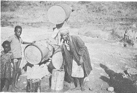
写真7 エブル地区の住民は 蒸気凝縮水より生活用水を確保している (写真は簡易型の凝縮水造成器)。
