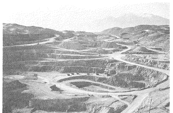
写真6 セロ・ベルデ鉱体の露天堀。(最下部の付近は初生硫化鉱帯に移化)
