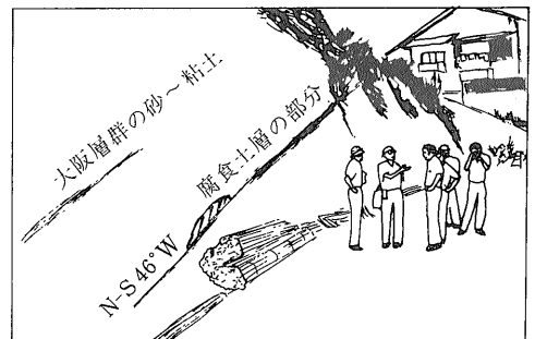
写真5 誉田断層による大阪層群の傾斜(第3図 Loc. 2) 説明図のように大阪層群の腐食土層が走向N-S 傾斜46°Wを示している
