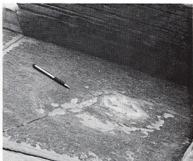
写真3 砂岩層の上面に見られる炭質物片（細長い暗色部） その平行配列により堆積時の水流の方向を示す（向 きは不明）。
