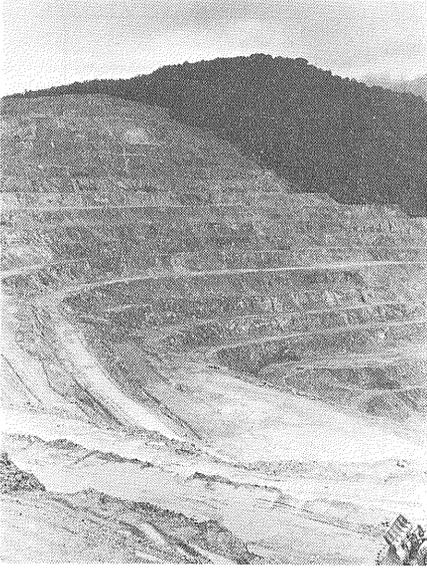
第7図 マムート鉱山の露天階段採掘場(左)。巨大なローダーで運搬し 各処で探鉱計画ボーリングが打たれている
