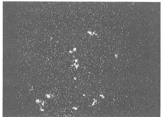
第6図 Allende 隕石中にみられる Ba 濃縮部分。この部分は Ti の濃縮部分に一致する。写真の横巾は 300μm。
