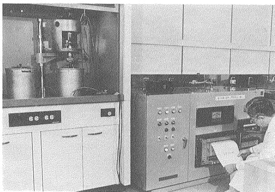
写真7 オートギーゼラープラストメーター (石炭の流動性測定装置)
