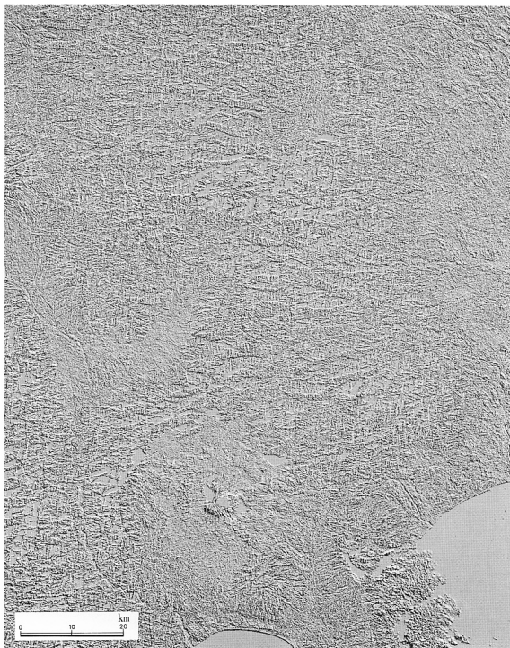
写真2 7バンド。1次微分 差分方向は北東—南西。箱根の湖 富山五湖のように湖面は白ぬき（輝色）であるが山地部に散在する同様の輝色部分は 当初の LANDSAT 映像の陰影（shadow）部分である。太陽光線は撮影時に南南東方向からなので 北北西側斜面には陰影が生ずる。表紙写真と比較して頂きたい。
