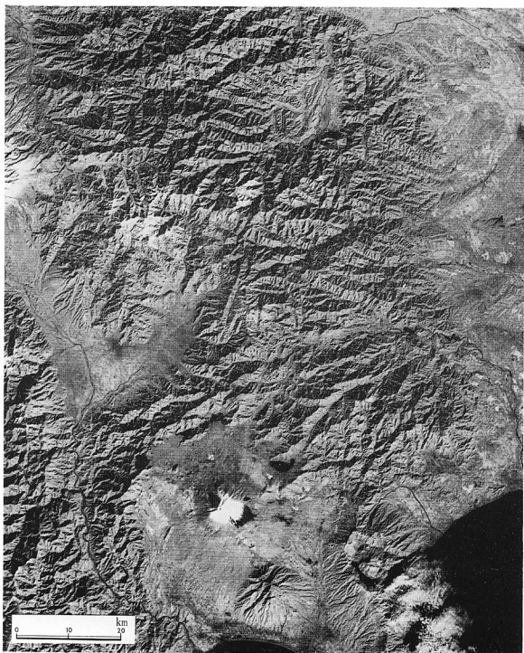
写真4 方向差分処理（エッジ強調処理）をする前の通常のLANDSAT映像写真。 7バンド。表紙および写真1～3と同一原画より作製された写真である。
