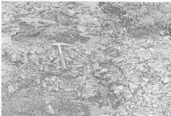
写真3 割れ目に富む古生層の酸性凝灰岩 (サンカンペン)
