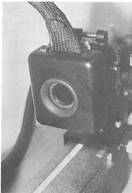
第8図 ㉕ 半導体光検出センサ・アレイを装備した検出部
