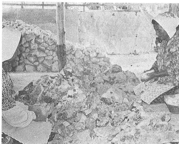
写真14 笠沙陶石の手選 小刀で水酸化鉄の多い部分を削り落す
