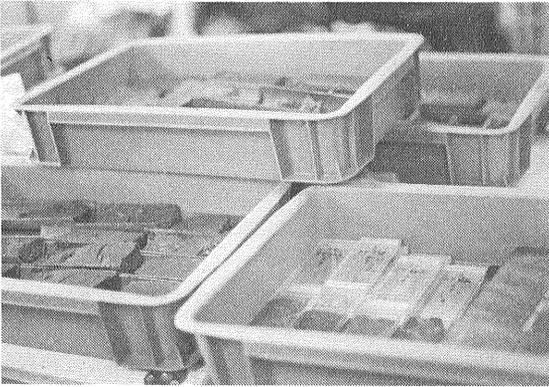
第15図 打抜きコアの処理 左下はコアを半割りにして写真撮影 右下は厚さ7mmの透明なケースにコアをスライスしたもの
