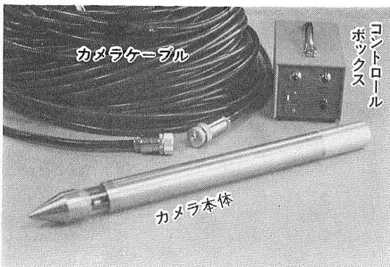
写真1 ボアホールカメラ装置の構成
