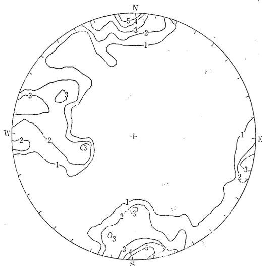
第12図 玄倉付近230個の割れ目方向角度図 シュミットネット下半球投影
