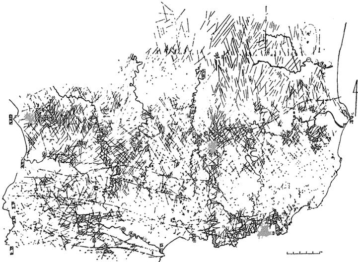
第3図 通常の航空写真判読によって作られた房総半島中部の線型構造 白石ら (1967) による
