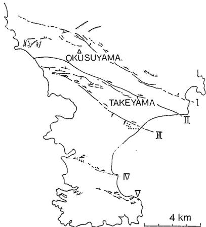
第8図 三浦半島の活断層系 KANEKO (1969) 原図 松田(1970)による I 衣笠断層; II 北武断層; III 武山断層; IV 南下浦断層
