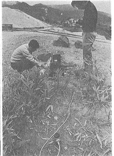
第10図 湯畑東北部地熱異常地での浅地下熱流量測定
