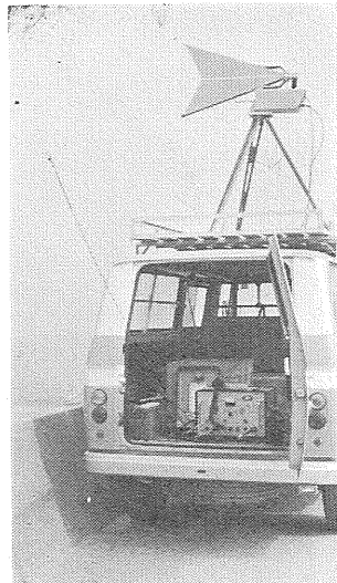
第14図 電波測量の従局 自動車に積込んでいるのが発信機 車上の三角形のものがアンテナ
