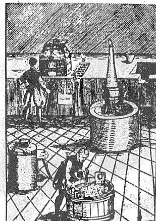
第4図 銀の中の金をしらべるための錬金術家たちの装置 分析炉 鉄の皿 フラスコなどがみえる
