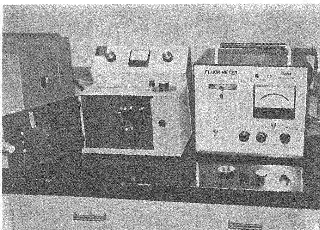
5 図 蛍光光度計 左は溶液用(ベリリウム等の分析に利用) 右は固体用(微量のウランの分析に利用) 右前は測定用ウランの試料とその作成に使う白金皿
