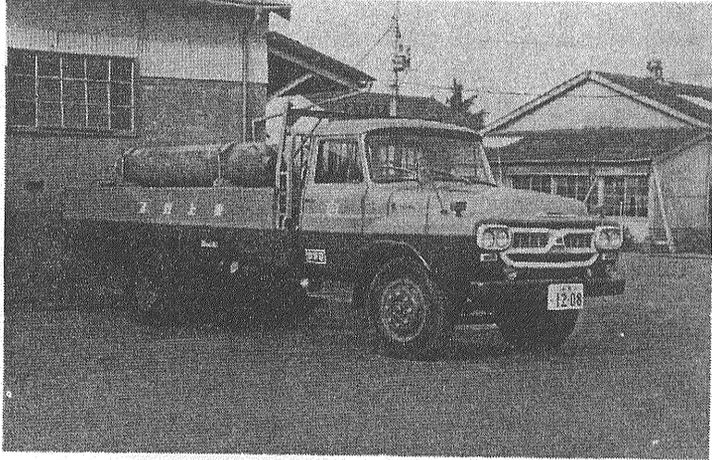
写真9 圧縮ガス運搬用のトラック これは充填中の写真で 東京近郊の団地では こうして運んだ天然ガスによる都市ガスの普及が進んでいる。
