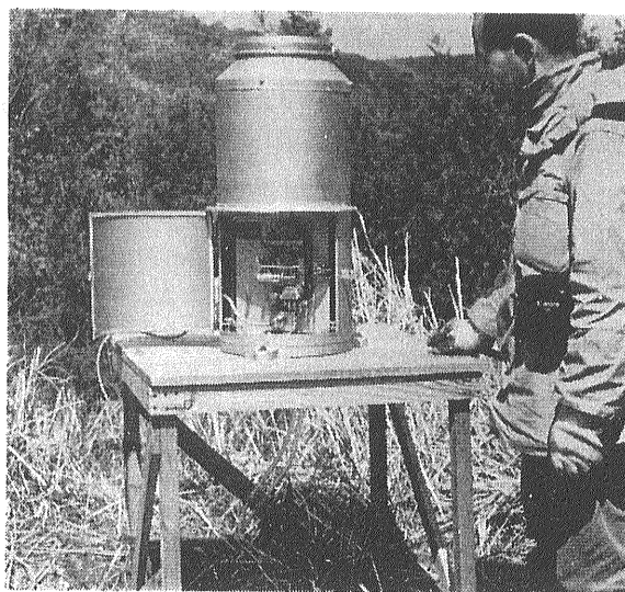
自記雨量計の設置
