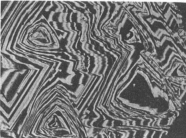
図6 8面体面の干渉写真(水銀の3本の波長を使って撮影したもの)ゆがんだ三角形は溶解によって隅が鈍角化した三角形の成長丘 逆むきの直線稜をもった三角形はトライゴン
