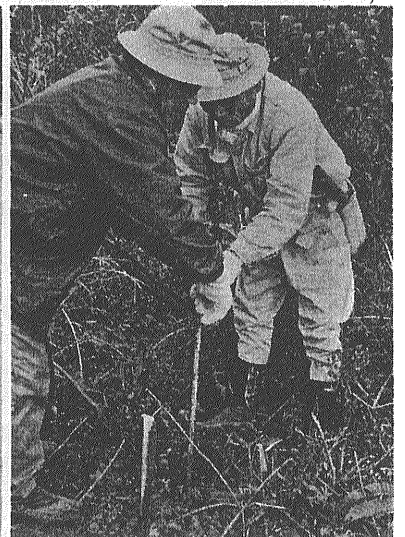
ハンドオーガーでガス採取孔を掘る 深度1m
