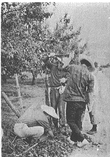
③ 土壌試料の採取 実験室に持ち帰り有機炭素および含水率などを測定する
