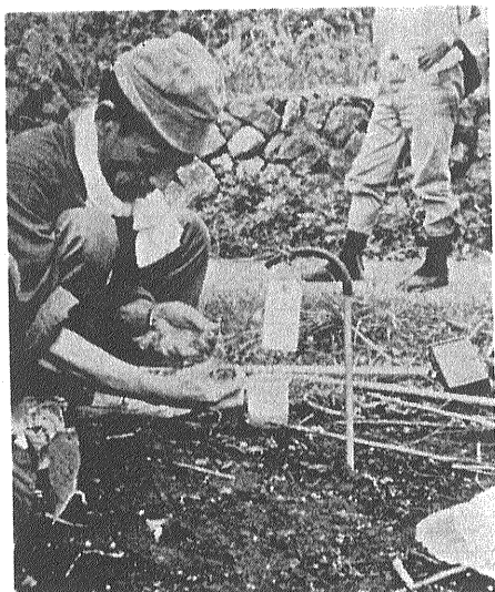
⑧ 土壌はさらにガス捕集管に移され 実験室に持ち帰ってガスクロマトグラフによって 成分の詳細な分析を行なう
