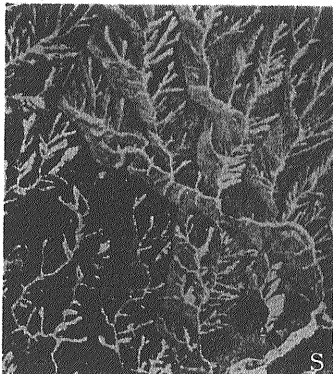
第23図 長野県大鹿村の花崗岩地帯で集中豪雨により発生した山崩れ
