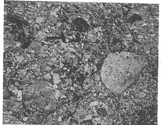
⑦ 鉱床の下盤になる大葛層の凝灰角礫岩
