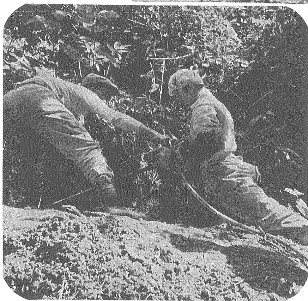
← 町役場の強い要望に応じて 水銀鉦床調査でパ ックサックを使用して試錐を行ない 鉦脈の連 続状態を確認した 右側の人物は素人相撲の大関で 左側は砂金掘 りの名人といわれている K氏 (中頓別水銀鉦山)
