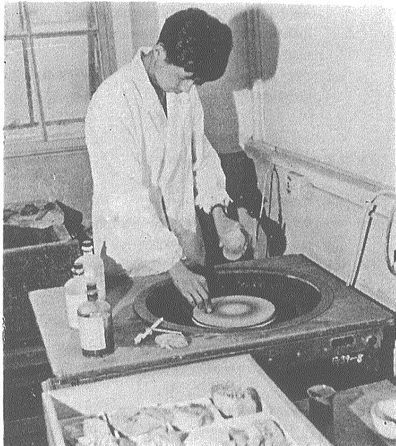
3,000 RPM 高速度ダイヤモンドブレード → による岩石の適正方位切断作業
