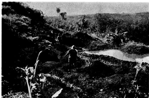
第2地区カダルマタン鉱床 残積すなわち現地砂礫 (eluvial) 鉱床の代表 表土 (平均厚さ 2 m) そのものが鉱床平均品位 (Mn 25%)
