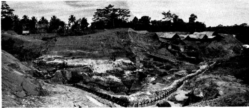
第1地区南コンペアン鉱床 → 現在最も生産の多い 鉱床 同時堆積性の鉱層とその下部にある凝灰岩の断層に天水成富化作用によって形成されたきわめて優良なレンズ状（イモヅル式に存在する） 鉱体とよりなる中央の深く掘り下げているのが 富鉄鉱体（平均品位 Mn 57% MnO 2 89%）左方 白いバンドの下に少し黒く見えるのが 鉄層（平均品位 Mn 15%）である
