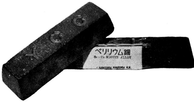
ベリリウム銅合金インゴット(Cu4%内外) 色…暗銅色〔原子力金属懇話会提供〕
