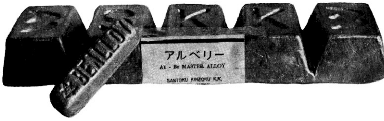
ベリリウム—アルミニウム合金インゴット (Be2%内外) 色…灰白色 光沢があり非常に軽い (原子力金属懇話会提供)
