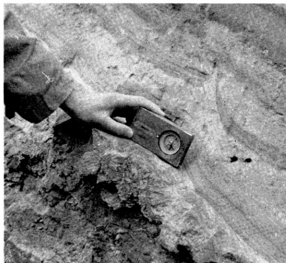
地層の走り方を示す「走向・傾斜」をはかり地質構造を調べる
