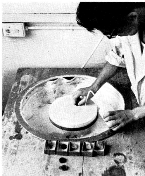
↑ ⑤ 研磨布上にアルミナ溶液をたらしながら最後のつや出し作業を行う
