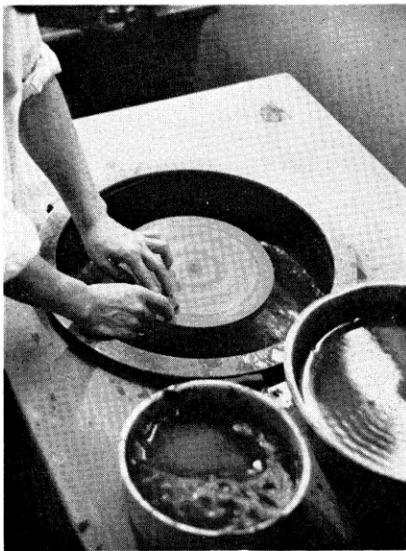
② 二連式研磨機で試料片をみがく
