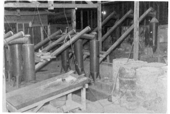
← 左…タンガーバルブ 右…放電管 (東芝KK提供) …………… レトリート炉のコンデンサー → (神生水銀鉱山提供)
