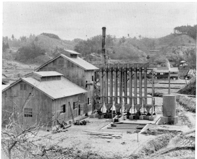
ロータリーキルンのコンデンサー (辰砂をロータリーキルンで気化した後水銀を含むガスを冷却筒に入れて濃集するコンデンサー) (神生水銀鋳山提供)
