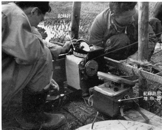
小型放射能検層器で検層中(宮城県大内)
