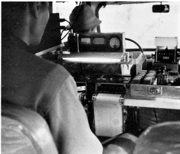
シンチレーションカウンターを備えた探査用ジープの内部
