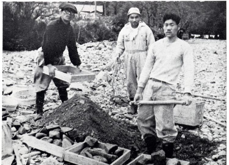
貯水池に流れ込む河川の河床礫のふるい分けによる粒度分析 (耳川水系上椎架貯水池小崎地先)
