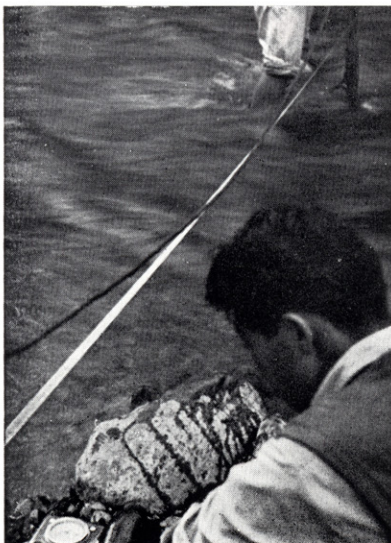
河川表流量測定 10~20km 2 に1点の割りで測定して比流量図をつくる
